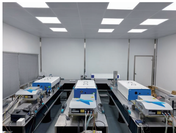
图3 1083 nm 激光发射系统,由三套相同的激光系统组成,三个激光束聚合为一束激光
