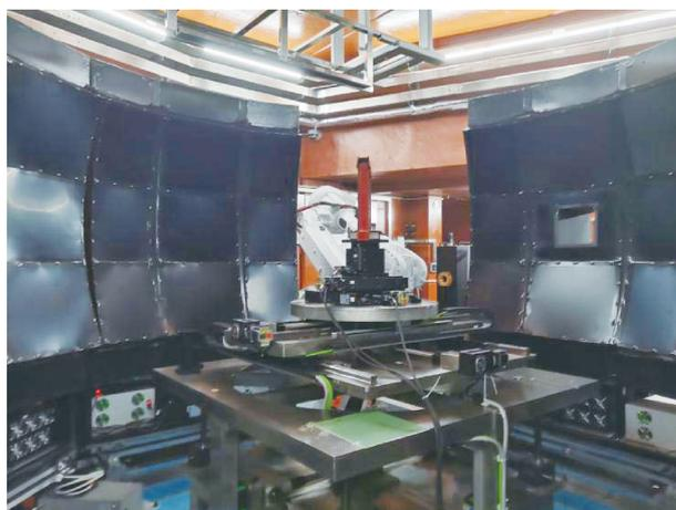
图2 中国散裂中子源中子衍射装置图
