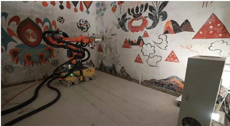
图3 可移动式智能电子束辐照装置图
