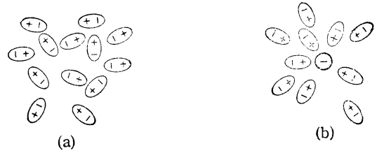
图 4 电极化的分子减小了电子的电荷效应.
