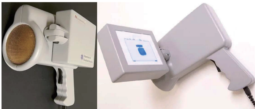
图9 美国物理光学公司的龙虾眼聚焦散射成像系统及成像效果示例
