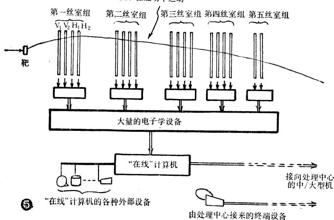
线路与更大的计算机系统相连。在整个实验中，在线计算机作为系统的一个中心控制部件，在线系统的软件，管理着实验的整个过程。实验人员可以通过电传机与计算机对话，检查实验进行情况，抽查实验采集的数据，修改实验安排等等。
