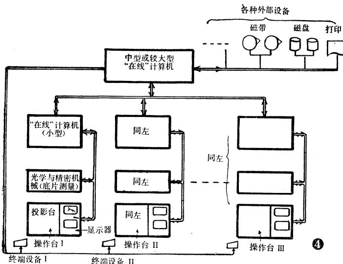
作一些相应的设置标志的操作，自动设备便在在线计算机软件(即计算机程序)控制下，自动完成寻找径迹、径迹扫描、几何重建和运动学处理。而且，通过扫描台上的显示器屏幕，把某些反映处理径迹的图形显示出来。一方面，操作人员可以通过显示的图形了解处理的情况；另一方面，也允许操作员根据情况通过键盘进行干预。这样的自动测量系统，每个测量台每小时可以自动测量几十个事例的数据。
