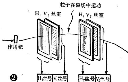
高能物理实验数据的采集与处理，依赖于电子计算机。由于实验方式不同，处理数据的具体方法当然有所区别。不过，笼统地可以把数据处理与分析过程划分为两个阶段：第一阶段是根据探测得到的原始数据，恢复粒子运动轨迹的完整空间曲线，这个过程实际是一个几何学的处理过程，一般称作“几何重建”；第二阶段是在经过几何重建后的数据基础上的具体分析与计算，一般地讲，是运动学和统计学处理的过程。进行高能物理实验，希望尽可能提高数据获取效率。通常情况下，一个泡室在一年内能得到几百万甚至近千万张照片，计数器实验的数据获取量可能要大得多。处理这些数据，工作量非常巨大，所以，高能物理实验中心都装备有庞大的计算机系统。
