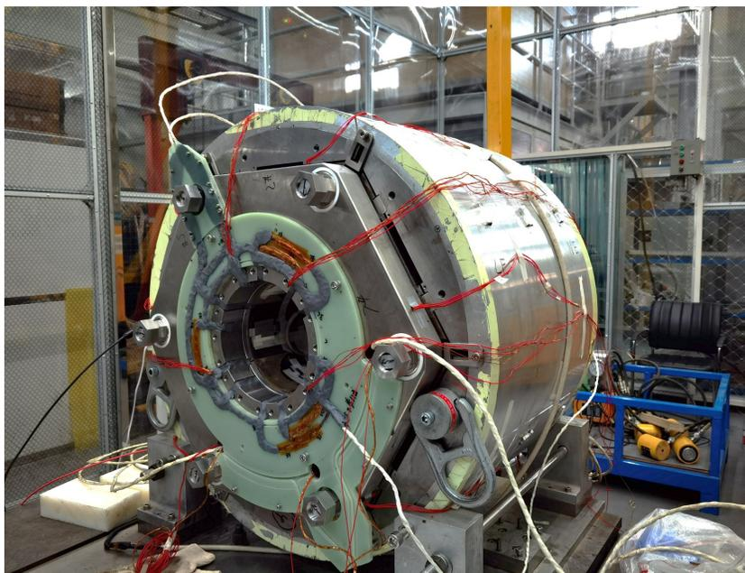
图 6 FECR 超导离子源磁体 1/2 尺寸样机
