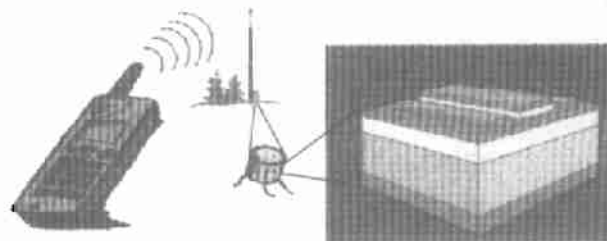
图1 在单元电话基地的快速晶体管中有半导体异质结结构
