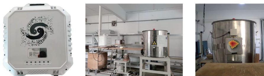
图12 中国科学院高能所研制的便携式快中子编码相机以及对Am-Be中子源成像结果
