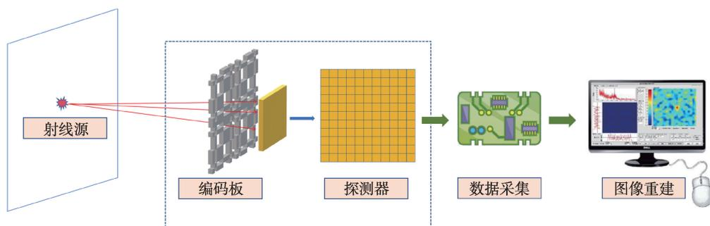
图3 编码孔径成像系统示意图
