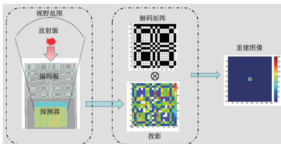
图9 19×19修正均匀冗余编码成像示意图
