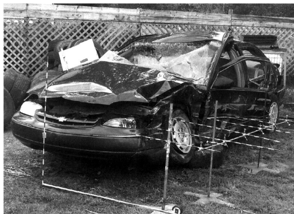
图 1 一辆中型小轿车的侧面被同等尺寸小轿车撞击后,乘客舱遭受严重挤压;在密歇根大学的一次汽车碰撞的研究中,测量系统确定了汽车车身相对于其原来表面的横向变形;正如文中所述,对真实道路交通事故和室内撞击试验进行的综合分析,将指导专业人员设计出更安全的汽车
