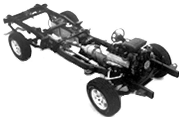
图6 2002款0.5吨道奇公羊(Dodge Ram)皮卡,它高而坚固的水平钢梁在事故中对被撞汽车非常危险;这种钢梁是大多数车身车架分离式轻型卡车的标准构件,乘客舱就独立地安装在上面,货厢可能焊接在坚固的底盘上
