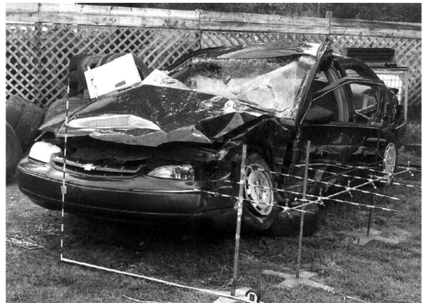
图1 一辆中型小轿车的侧面被同等尺寸小轿车撞击后,乘客舱遭受严重挤压;在密歇根大学的一次汽车碰撞的研究中,测量系统确定了汽车车身相对于其原来表面的横向变形;正如文中所述,对真实道路交通事故和室内撞击试验进行的综合分析,将指导专业人员设计出更安全的汽车
