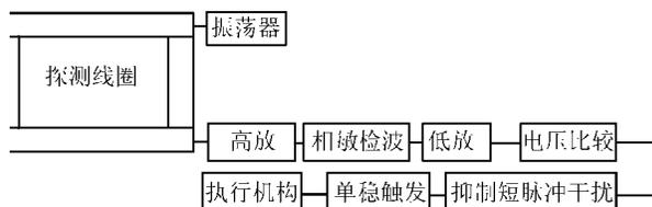
物质将局部加强原交变磁场,非铁磁物质将局部减弱原交变磁场。接收线圈按差分形式设计,在无外界金属通过时,其输出处于平衡状态;当有金属通过时,探测区交变磁场受到干扰,破坏了探头的平衡状态,从而使探测线圈的输出端有一微弱变化的交变电压输出,这一微弱的电压信号经高放、相敏检波、低放、电压比较、抑制短脉冲干扰、单稳触发等电子控制电路后,将包含在输出信号幅度和相位中的“有金属”信息分离出来,作为声、光报警和执行机构的控制信号。最后由继电器发出执行信号,送到自动执行机构,从而自动报警,或将含有金属的物体检出。
