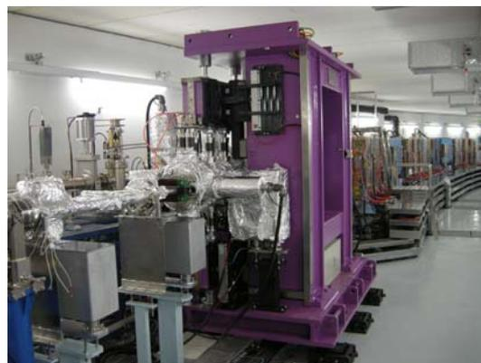
图 5 上海光源储存环上安装的真空内插入件
