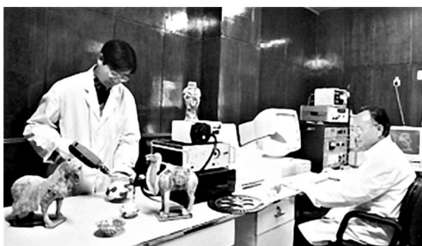
图 6 上海博物馆文物保护与考古科学实验室对陶瓷进行热释光测年
