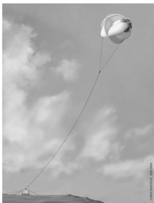
图2 高空风力发电机通过电缆和地面相连
