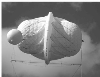
图3 高空风力发电机像飞艇
