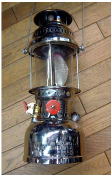
图 4 可以高温燃烧的汽灯 玻璃灯罩内的白色网是作灯芯的纱罩没有用过时很软， 烧过之后就变成很脆硬的网罩了
