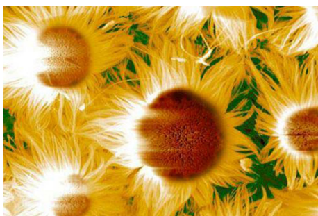
图 4 氧化锌纳米线构成的向日葵结构
