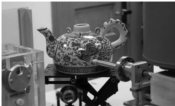
图1 古陶瓷的XRF无损分析
