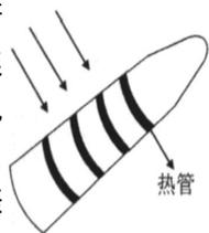
图3 航天器外壁上的热管
