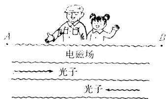
图 15 电磁场传递电磁相互作用。 电磁场的量子是光子。 A, B 是两个电荷。
