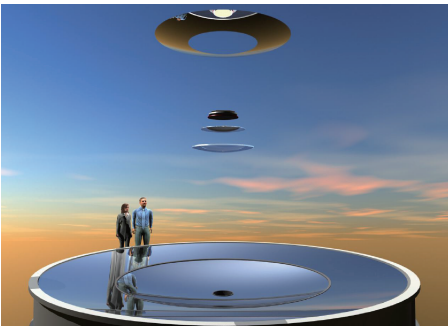
图 2 西蒙尼巡天望远镜光学系统 (图片来源:NSF-DOE Vera C. Rubin Observatory/ NOIRLab/SLAC/AURA)
