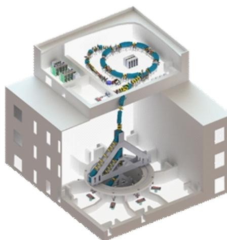
图19 近物所设计的新型重离子治疗装置
