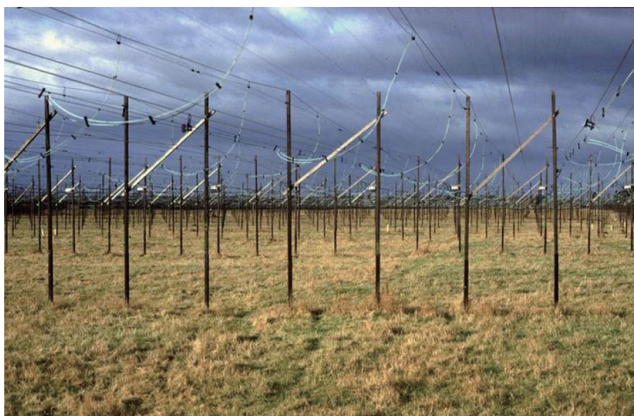
图3 国际首台行星际闪烁射电望远镜,其构成是偶极天线阵列(来源:英国剑桥大学网页)
