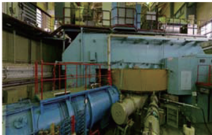
图16 U400是前苏联建造的一个等时性回旋加速器,1978年投入运行,可将质量数 A=4-209 的重粒子加速到 29-3\text{ MeV/u}
