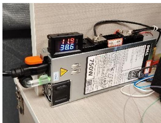
图 7 云室底板温度达-55.6度 半导体制冷片电流为 38.6 安培
