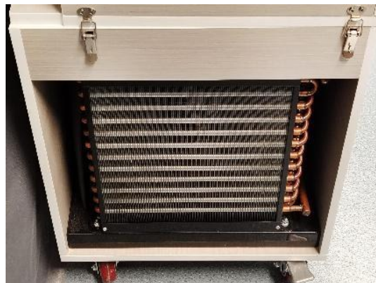
图5 鱼池冷水机改造后的热交换散热通道
