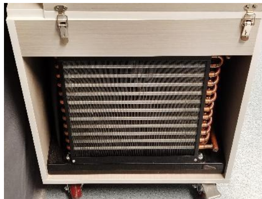
图5 鱼池冷水机改造后的热交换散热通道
