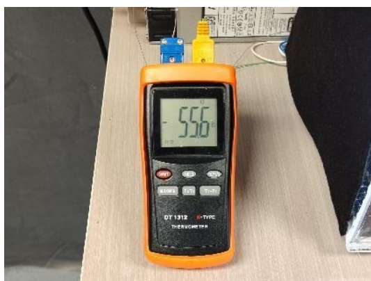
图 7 云室底板温度达-55.6度 半导体制冷片电流为 38.6 安培
