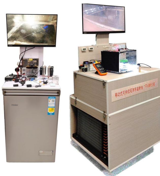
图1 移动式不间断云室的冰箱1.0版及冷水机2.0版
