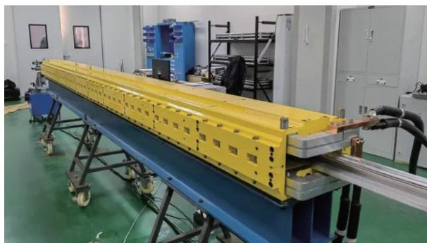
图4 增强器研发:CEPC增强器的全尺寸二极磁铁样机(资料来源:高能所)
