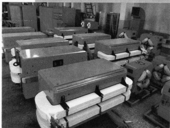
二极磁铁与四极磁铁 静电分离器进行超高真空试验
