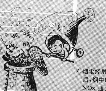
7. 烟尘经射线照射后，烟中的 $SO_2$ 、 $NO_x$ 通过化学反应生成酸雾被电集尘器清除，改善环境保护。
