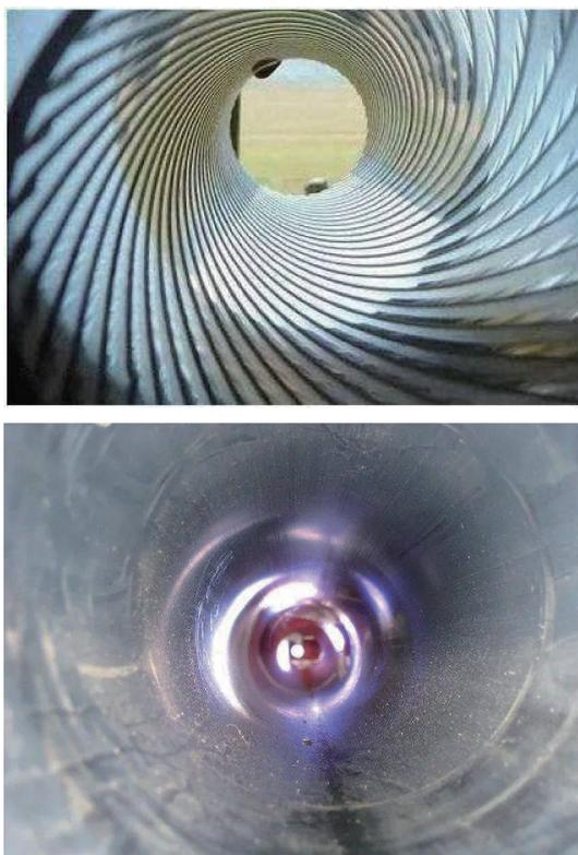
图7 挑战者2的L30A1线膛炮(上)与莱茵金属120毫米滑膛炮(下)内部结构图
