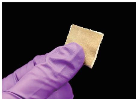
研究人员认为,与人类皮肤通过触摸动作感知大部分信息不同,这种人造皮肤还能从非触摸或接近操作中获得丰富的认知信息,并可能导致下一代机器人感知技术优于现有的触觉传感器。
