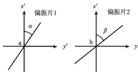
图 3 两个线偏振片 1 和 2, 用于对通过 a 和 b 的光子进行符合测量角度。我们可以使用它们对通过 a 和 b 的两个光子进行同时测量。将同时找到通过偏振片 1 和 2 的两个光子的概率记为  $P(\alpha, \beta)$ 。或者,  $P(\alpha, \beta)$  也可视为与通过两个偏振器的光(在适当的叠加之后)的强度的乘积成正比。将  $\alpha + \pi/2$  和  $\beta + \pi/2$  分别表示为  $\alpha_\perp$  和  $\beta_\perp$ 。
