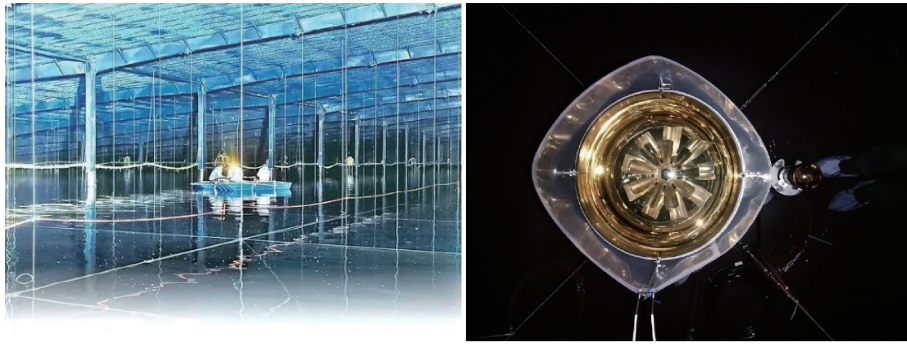
图3 LHAASO的水切伦科夫探测器阵列 WCDA。左图为水池内部,右图为一个单元中安装的两尺寸的光电倍增管 [7]
