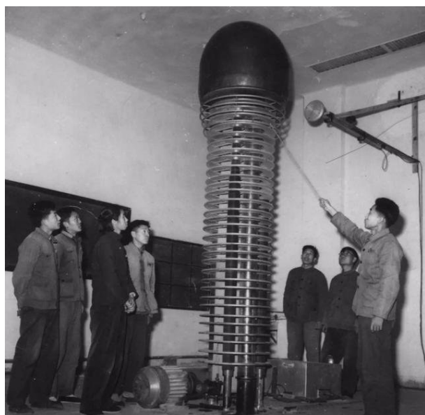
图7 1958年赵忠尧主持研制成功250万电子伏的质子静电加速器
