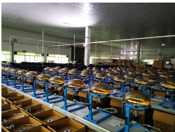
图2 江门中微子实验的20英寸光电倍增管
