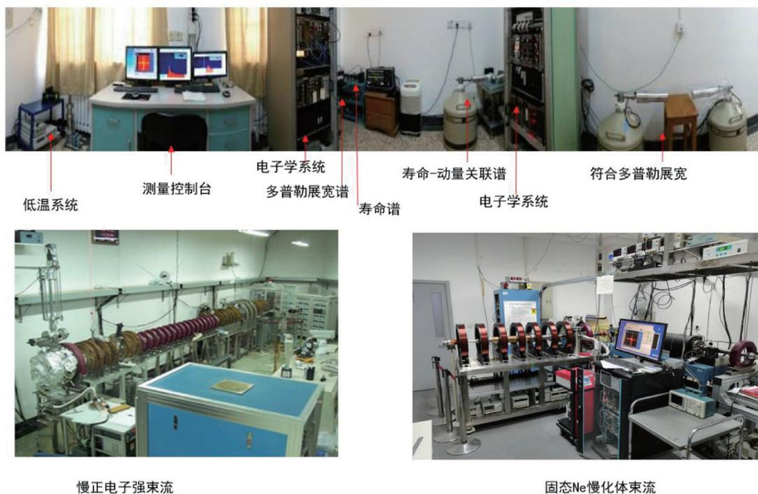
图1 高性能正电子多参数实验平台
