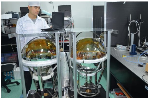
图 10 夏经铠博士在实验室测试 20 吋样管
