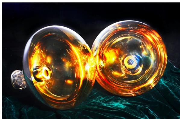
图7 20吋大面积MCP-PMT样管
