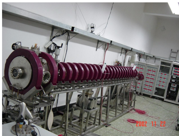
图2 强流慢正电子束装置
