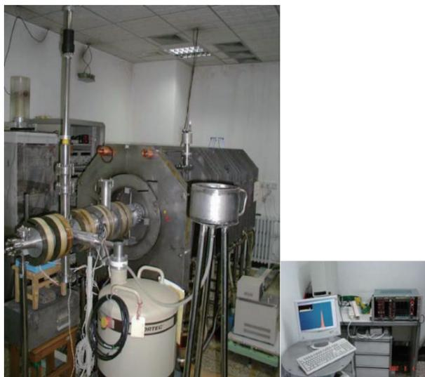
图3 建成的北京慢正电子束流装置
