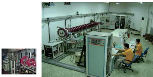
图4 基于北京正负电子对撞机LINAC的慢正电子强束流装置
