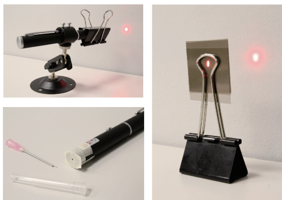
图19 利用大夹子保持激光器开启,使用胶带和针控制激光束大小,使用衰减片降低激光强度的示意图
