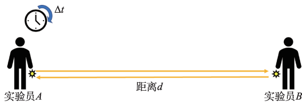
图1 伽利略设计的光速测量实验原理图(为了更好的显示效果, 该图中人形比例经过放大)
