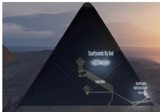
图8 通过缪子成像技术测量的到金字塔内部的密室⑤
