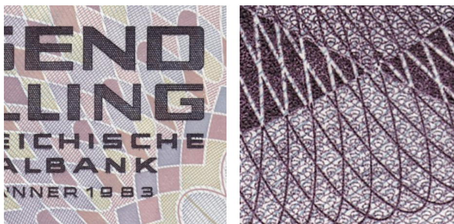
图5 奥洛夫印刷法印刷的多色线条和精密机雕花纹
