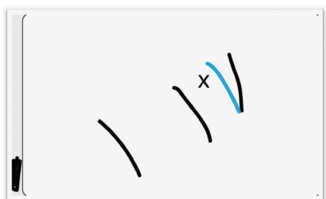
图16 放入小磁铁后波脉冲传播示意图
