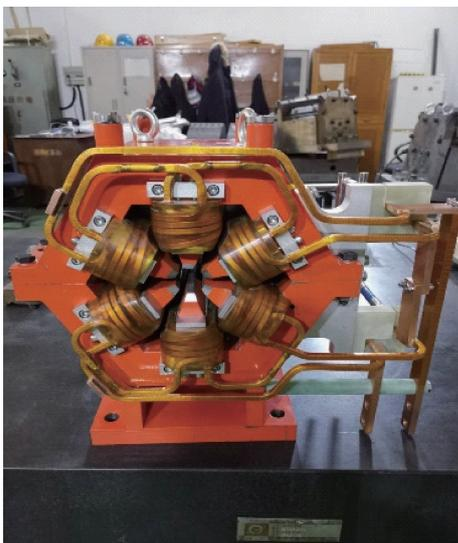
图7 小间隙六极磁铁样机
