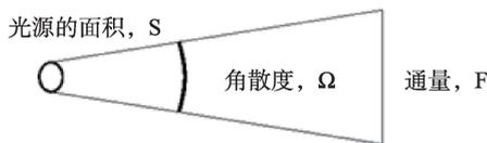
图2 通量(Flux)一定的情况下,光源的面积(Source area)和角散度(Angular divergence)越小,就越亮
