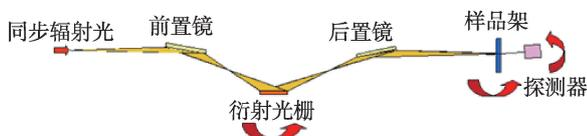
图2 国家同步辐射实验室光谱辐射标准与计量线的球面光栅单色器示意图<sup>③</sup>
