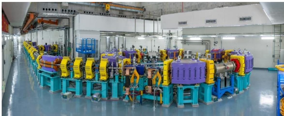
图4 2017年建成的上海质子治疗同步加速器
