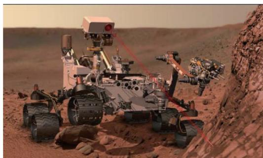
图11 火星车使用化学相机检测岩石样品化学成分的艺术构想图
