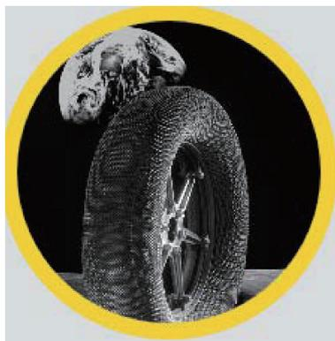
图8 固特异与NASA共同发明的弹簧轮胎(图片来源:固特异轮胎中国官网<https://www.goodyear.com.cn>)
