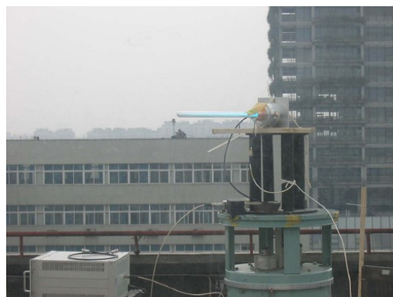
图3 柱形气态等离子体天线实物图 (引自中国科学院空间科学与应用研究中心赵国伟博士学位论文)
