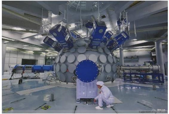
图12 神光-III装置激光大厅靶室
