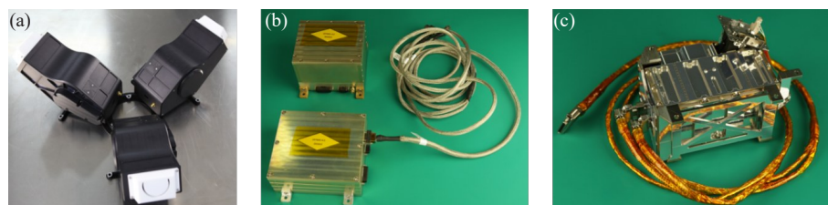
图1 (a)荷兰低频射电探测仪;(b)德国月表中子与辐射剂量探测仪;(c)瑞典中性原子探测仪
