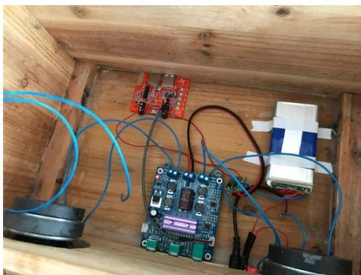
图10 太阳能蓝牙音箱内部结构图
